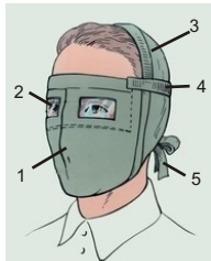
ПТМ: 1-корпус; 2-смотровые отверстия; 3-крепление; 4-поперечная резинка; 5-завязки.
